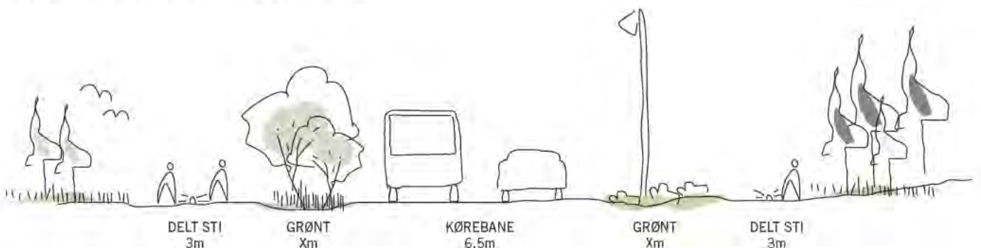
FIG. 38: VEJSNIT PERIMETERVEJ - GENERELT SNIT
